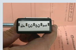
②CK-1 本体をゲージに合わせる。③しっかり強く押す
